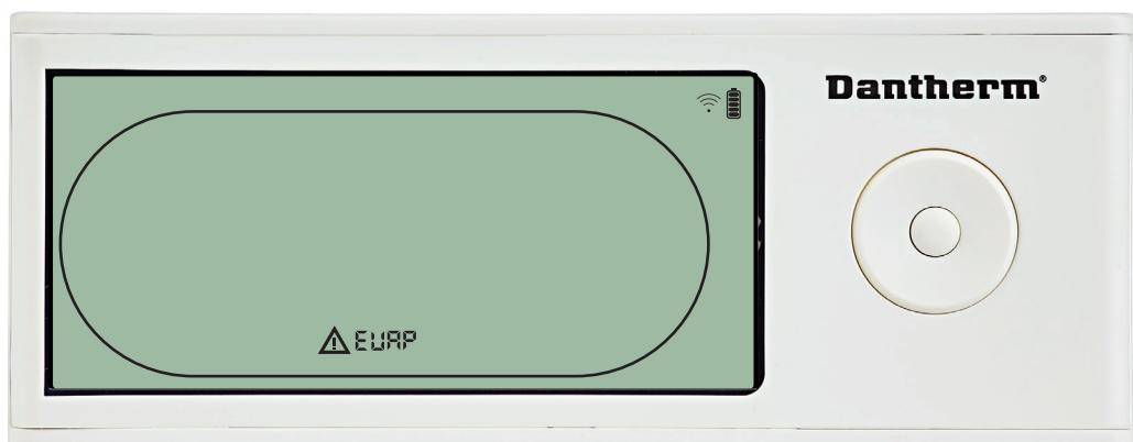
Hvis fordampersensoren er fejlbehæftet, vises koden "EVAP", når der trykkes på OP eller NED, mens displayet viser sensorfejlkoden "SEnS".
