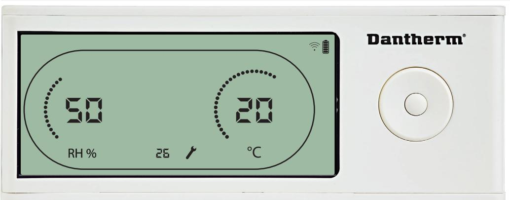
Lorsque l'icône clignote, l'intervalle d'entretien peut être augmenté en appuyant sur le bouton DROITE ou diminué en appuyant sur le bouton GAUCHE. Maximum 99 semaines. Minimum 1 semaine.
