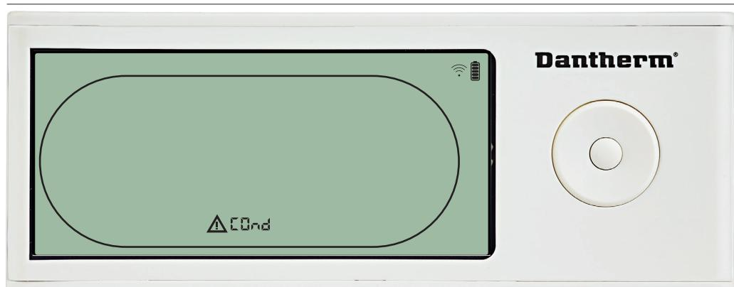
Se il sensore del condensatore è guasto, il codice "COnd" apparirà premendo SU o GIÙ quando sulla schermata appare il codice di guasto sensore "SEnS".
