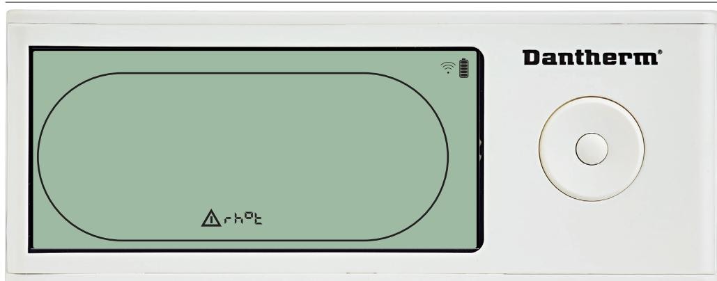
Hvis RH/T-sensoren er fejlbehæftet, vises koden "rh°t", når der trykkes på OP eller NED, mens displayet viser sensorfejlkoden "SEnS".
