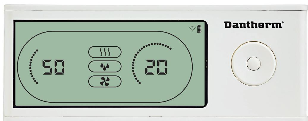
Wenn der Luftentfeuchter läuft, wird das Entfeuchtungssymbol (💧) im Display der DRC1 eingeblendet.
