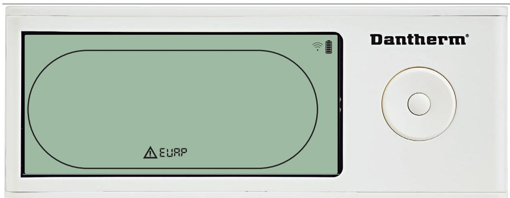
Si el sensor del evaporador está defectuoso, el código «EVAP» se mostrará al pulsar los botones ARRIBA o ABAJO cuando en la pantalla se muestra el código de fallo de sensor «SEnS».
