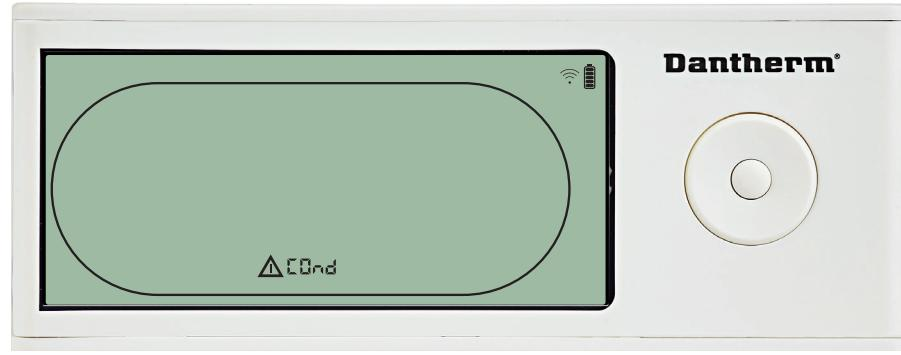
Jeżeli awarii uległ czujnik skraplacza, podczas gdy ekran wyświetla kod awarii czujnika "SEns", w wyniku przyciskania strzałek GÓRA/DÓŁ wyświetli się kod "COnD".
