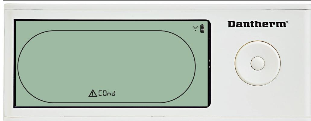
Se o sensor do condensador estiver avariado, é exibido o código "COnD", quando premir PARA CIMA ou PARA BAIXO, com o ecrã a exibir o código de falha do sensor "SEnS".
