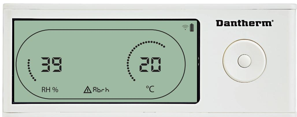
Die DRC1 geht in den Standby-Modus 2, wenn die Umgebungsbedingungen außerhalb des zulässigen Bereichs liegen. Das Display zeigt die Temperatur- und RH-Messwerte an, wenn das Gerät im Standby-Modus 1 ist. Dieser Zustand wird erst dann aufgehoben, wenn die Umgebungstemperatur (Abt) oder die Umgebungsfeuchtigkeit (Abrh) auf zulässige Werte zurückkehren. Dieser Zustand ist nicht quittierbar.
