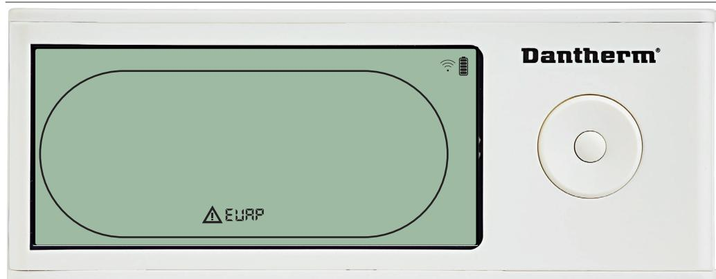
Se o sensor do evaporador estiver avariado, é exibido o código "EVAP", quando premir PARA CIMA ou PARA BAIXO, com o ecrã a exibir o código de falha do sensor "SEnS".
