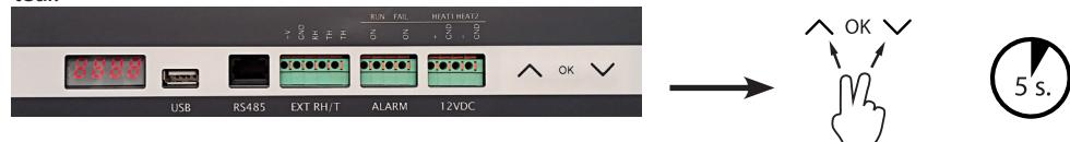
Si cette procédure ne fonctionne pas: Éteindre le déshumidificateur et attendre 5 secondes avant de le remettre sous tension.
