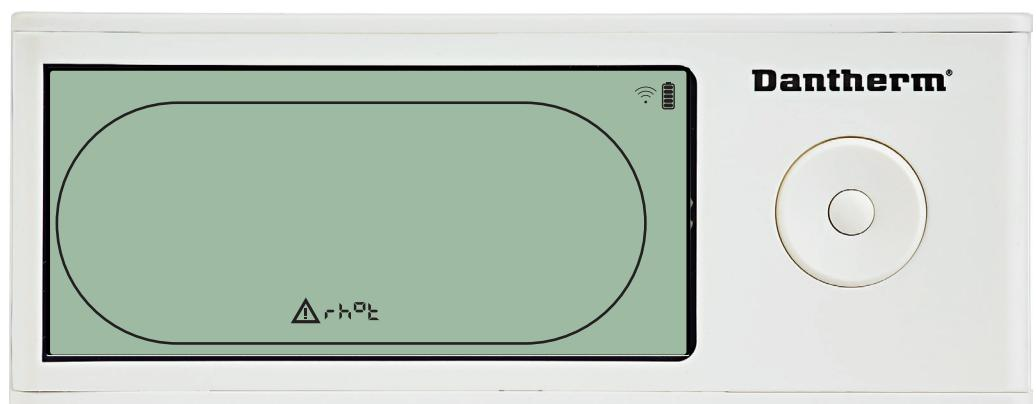
Ist der RH/T-Sensor gestört, wird der Code „rh°t“ angezeigt, wenn aus der Sensorstörungscode-Anzeige „SEnS“ heraus die Hoch- oder Runter-Taste betätigt wird.
