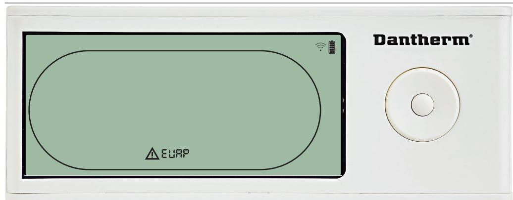
Ist der Verdampfersensor gestört, wird der Code „EVAP“ angezeigt, wenn aus der Sensorstörungscode-Anzeige „SEnS“ heraus die Hoch- oder Runter-Taste betätigt wird.
