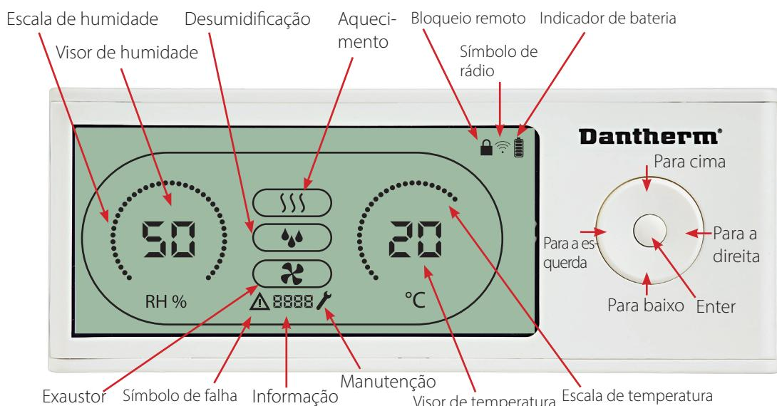
Escala de humidade e temperatura.
