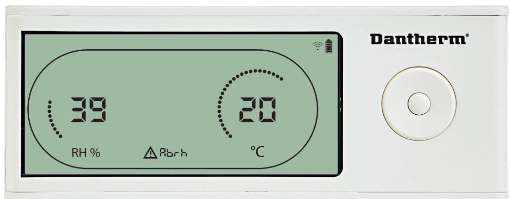
Sul display appariranno le letture di temperatura e di Rh quando l'unità è in modalità standby 1. Tale stato verrà corretto soltanto quando la temperatura ambiente (abt) o l'umidità ambiente (abrh) sono all'interno del campo, e non può essere disattivato.
