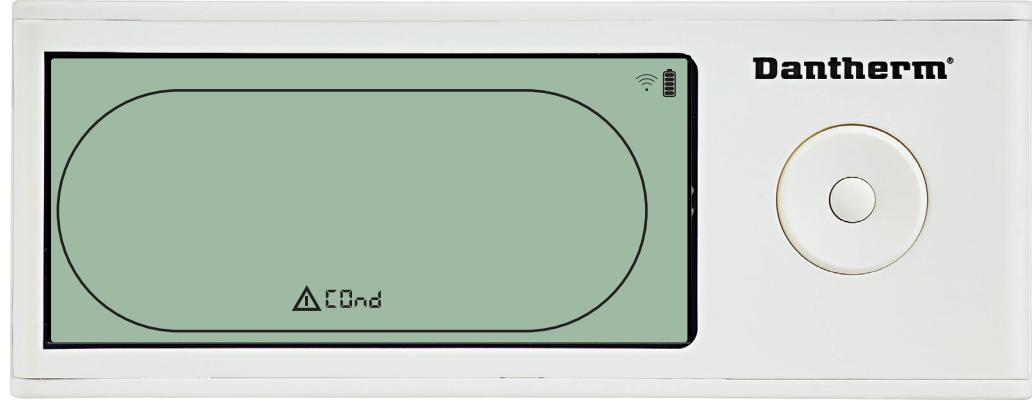
Hvis kondensorsensoren er fejlbehæftet, vises koden "COnD", når der trykkes på OP eller NED, mens displayet viser sensorfejlkoden "SEnS". Hvis der ikke trykkes på nogen knapper inden 10 sekunder, skifter displayet tilbage til "SEnS". Det er ikke muligt at åbne menuopsætningen for at ændre sætpunkt.
