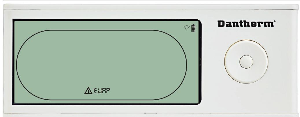
В случае неисправности датчика испарителя при нажатии кнопок Вверх или Вниз, когда на дисплее отображается код неисправности «SEnS», будет отображаться код «EVAP».
