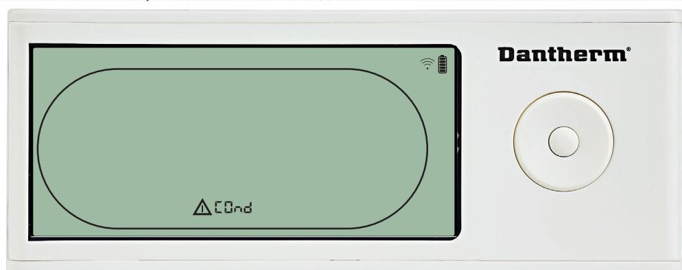
В случае неисправности датчика конденсатора при нажатии кнопок Вверх или Вниз, когда на дисплее отображается код неисправности «SEnS», будет отображаться код «COnd».
