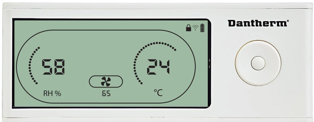
Cuando el ícono del ventilador extractor parpadea a 0,5 Hz y el valor del punto de ajuste del ventilador extractor se muestra en la línea de información.
