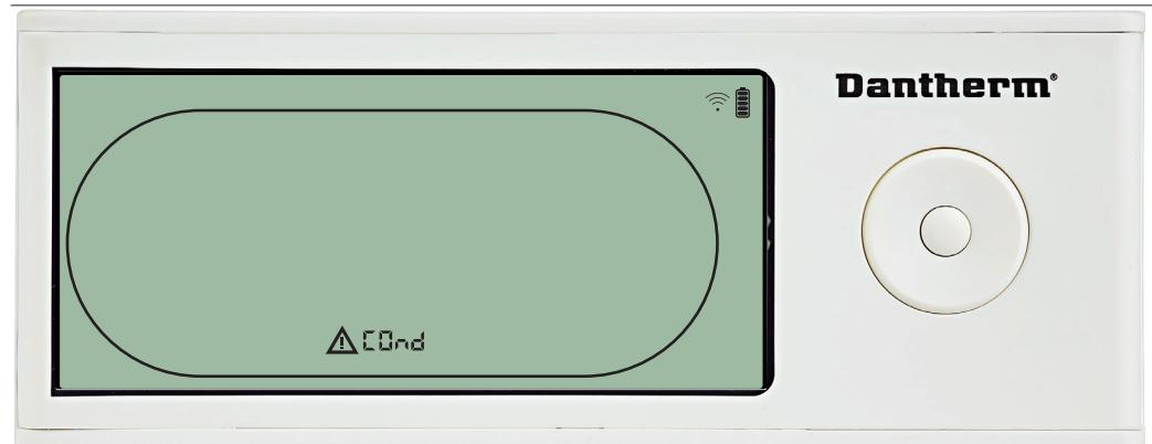
Si le capteur du condensateur est défectueux, le code « COnd » est affiché si vous appuyez sur HAUT ou BAS lorsque le code d'échec « SEnS » est affiché à l'écran. Si vous n'appuyez sur aucun bouton pendant 10 secondes, l'écran affiche à nouveau « SEnS ». Il est impossible d'accéder au menu de configuration pour mesurer les points de consigne.
