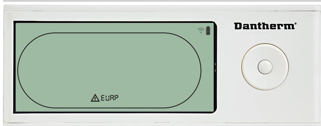
Als de verdampersensor defect is, wordt de code "EVAP" weergegeven als u op OMHOOG of OMLAAG drukt wanneer op het scherm de sensorstoringscode "SEnS" wordt weergegeven.
