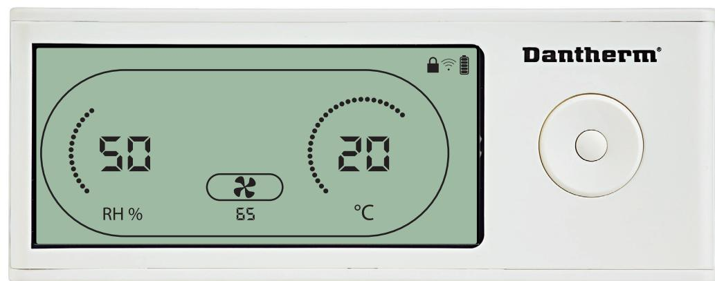
Når udsugningsventilatorikonet blinker med en takt på 0,5 Hz, og sætpunktværdien for udsugningsventilatoren vises i informationslinjen, kan knapperne Venstre og Højre bruges til at forøge og reducere værdien. Tryk for at bekræfte sætpunktet og fortsætte til næste ikon.
