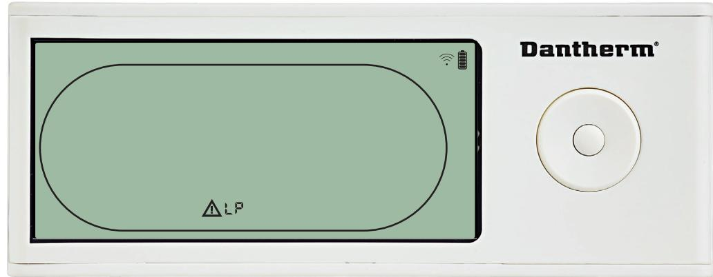
Il deumidificatore si è arrestato a causa del rilevamento di bassa pressione.
