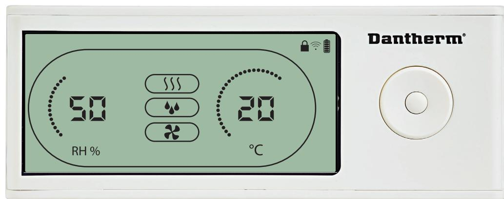
Панель управления DRC1 оборудована выключателем, находящимся в батарейном отсеке. При переводе выключателя в положение «lock» кнопки панели управления становятся неактивными. Дисплей по-прежнему будет отображать информацию, но ввод информации пользователем будет невозможен.
