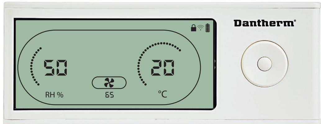
Lorsque l'icône du ventilateur d'extraction clignote à une fréquence de 0,5 Hz, le point de consigne du ventilateur d'extraction est affiché sur la ligne d'information. Appuyez sur le bouton Gauche ou Droite pour diminuer ou augmenter la valeur. Appuyez sur entrée pour confirmer le point de consigne et accéder à l'icône suivante. Si vous ne confirmez pas les modifications, le nouveau point de consigne ne sera pas enregistré.
