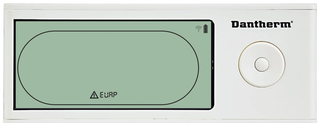
Se il sensore dell'evaporatore è guasto, il codice "EVAP" apparirà premendo SU o GIÙ quando sulla schermata appare il codice di guasto sensore "SEnS".
