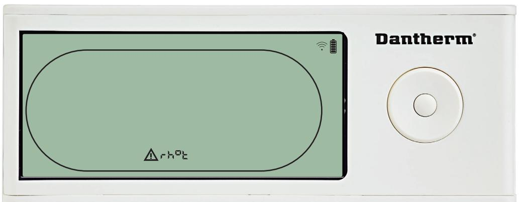
Si el sensor de HR/T está defectuoso, el código «rh°t» se mostrará al pulsar los botones ARRIBA o ABAJO cuando en la pantalla se muestra el código de fallo de sensor «SEnS».
