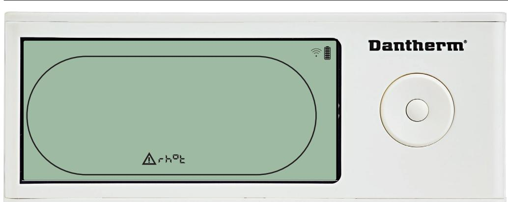
Se o sensor de HR/T estiver avariado, é exibido o código "rh°t", quando premir PARA CIMA ou PARA BAIXO, com o ecrã a exibir o código de falha do sensor "SEnS".
