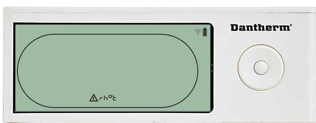
Als de RH/T-sensor defect is, wordt de code "rh°t" weergegeven als u op OMHOOG of OMLAAG drukt wanneer op het scherm de sensorstoringscode "SEnS" wordt weergegeven.
