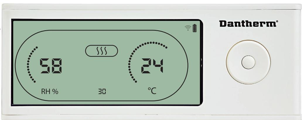
De temperatuurwaarde en het verwarmingspictogram knipperen. De weergegeven waarde toont het gewenste temperatuursetpoint. Tijdens het knipperen kan de waarde worden verhoogd of verlaagd door op de knop Omhoog/verhogen of Omlaag/verlagen op de DRC1 te drukken. Maximum: 32 °C, minimum: 5 °C. Druk op Invoeren om het nieuwe setpoint te bevestigen en naar de volgende menupagina te gaan.
