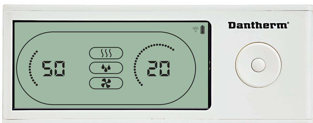
Lorsque le déshumidificateur est en fonctionnement, le symbole de déshumidification ( ) est affiché à l'écran du DRC1.
