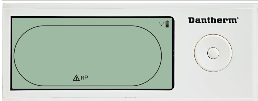
Осушитель прекращает работу при обнаружении чрезмерно высокого давления.
