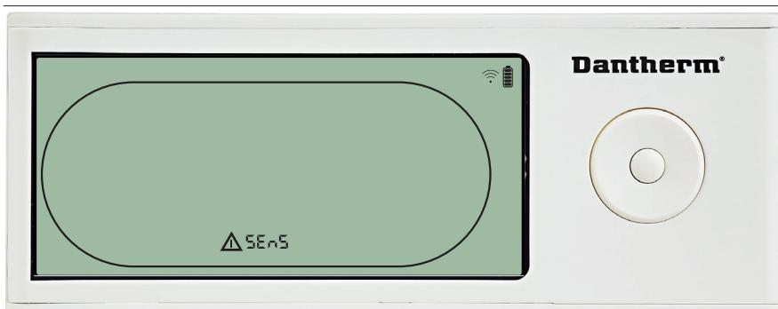
El deshumidificador se detiene porque se ha detectado un fallo de sensor.
