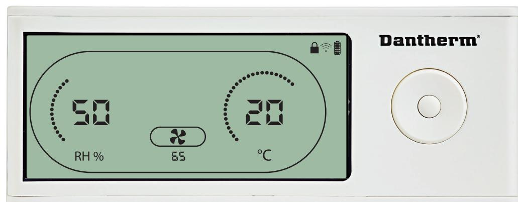
Символ вытяжного вентилятора мигает с частотой 0,5 Гц, в информационной строке указано заданное значение для вытяжного вентилятора.
