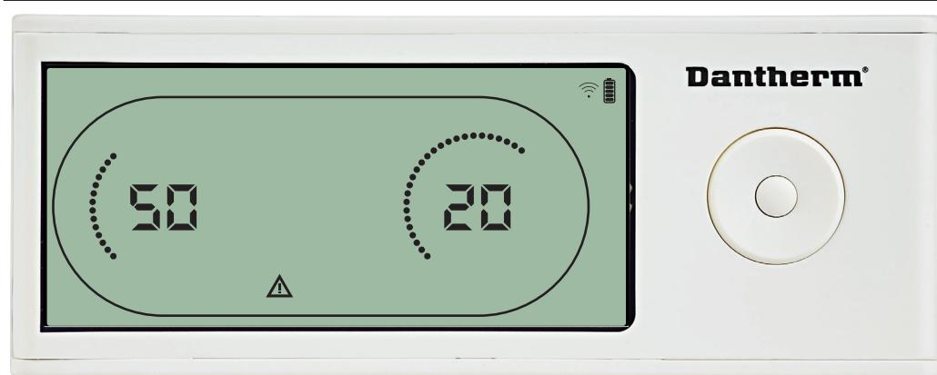
Se l'umidificatore entra in modalità guasto, il segnale di pericolo (⚠) appare sul display di DRC1.
