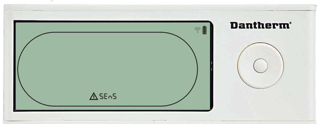
Affugteren stoppes, fordi der er detekteret en sensorfejl. Sensorfejl kan ikke tilsidesættes fra DRC1. Brug OP- eller NED-knappen til at få vist, hvilken sensor/hvilke sensorer der er defekt. Hvis alle sensorerne er defekte, vises disse koder i følgende rækkefølge: "COnD"  $\uparrow$  "EVAP"  $\uparrow$  "rh<sup>ø</sup>t". Det er ikke muligt at åbne menuopsætningen for at ændre sætpunktværdierne.
