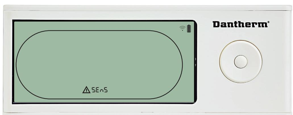
O desumidificador é parado devido à deteção de uma falha do sensor. A falha do sensor não pode ser ignorada no DRC1.
