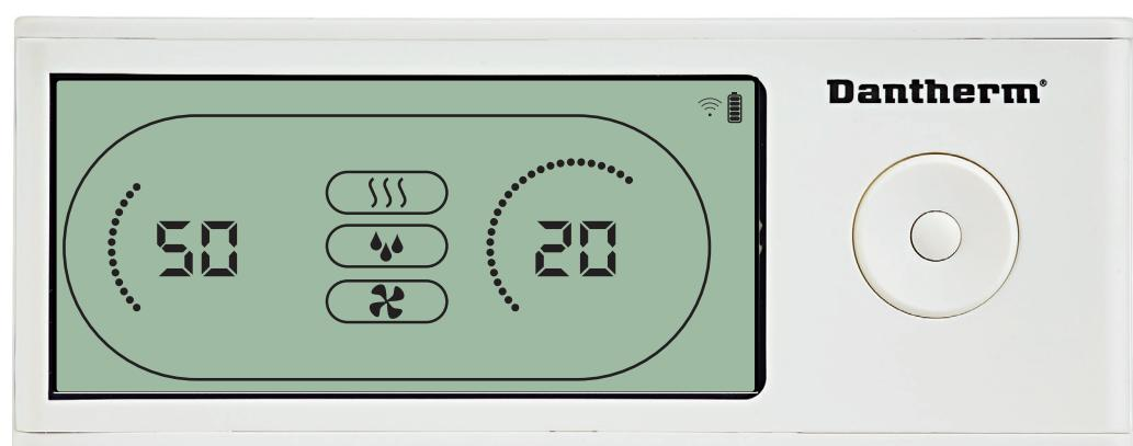
Во время работы осушителя на дисплее панели управления DRC1 отображается символ осушки.💧
