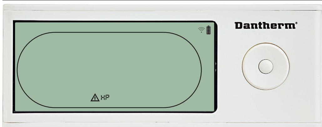
O desumidificador para devido à deteção de alta pressão.
